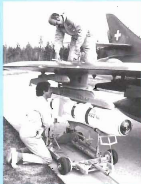
Schweiziska tekniska myndigheterna har utvecklat robot typ Maverick på Hawker Hunter. — Foto: Schweiz
