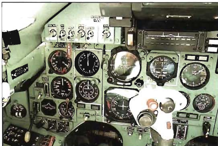
Ovan: Instrumentpanelen på fabriksversionen av Su-27 var i år av "gamaldags" snitt. Notera dock det runda instrumentet längst tv i den övre raden: En kombinerad anfallsvinkel- och G-mätare. ( \alpha tv och G th.)
