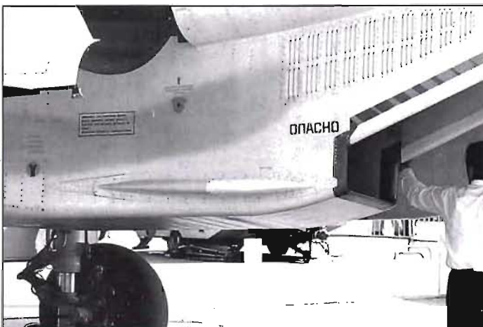
Radarvarnarsystemet ger varning i framifrånsektorn i 20° sektorer och i bakifrånsektorn endast i 90° sektorer. Mottagarantennerna är placerade på flygkroppen vid sidan av luftintagen (nedan) respektive (ovan) på den högra fenans bakkant (de nedersta små halvsfäriska antennenparet). Systemet ger också varning om hotet kommer uppfifrån eller nerifrån samt ger föraren en viss information av typ av hot.
