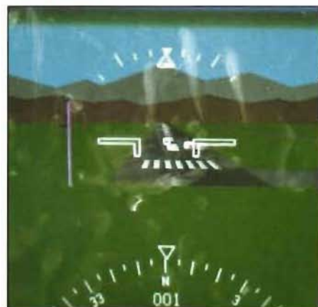
Exempel på presentationssystem för GPS-landning (Tunnelpresentation. Observera terrängen i bakgrunden.)
