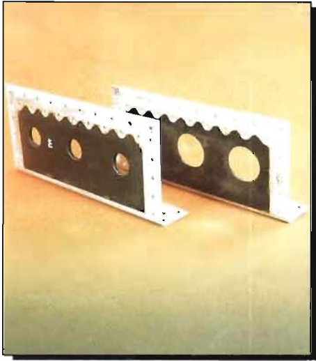
Reparerade provbalkar till SK 60. De svarta laglapparna är tillverkade i kollfiberkomposit.
