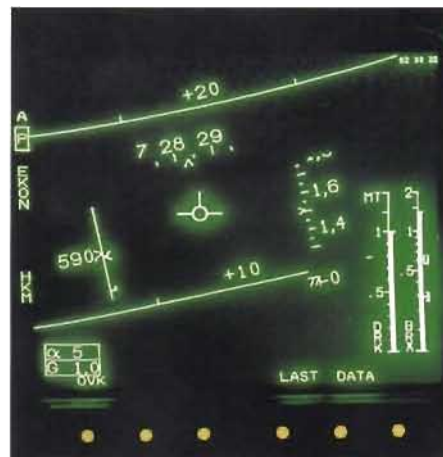
Presentationssystemets flexibilitet gör att viktig information kan flyttas mellan indikatorerna. Här har SI (siktlinjesindikatorns) info förts över till FI.
