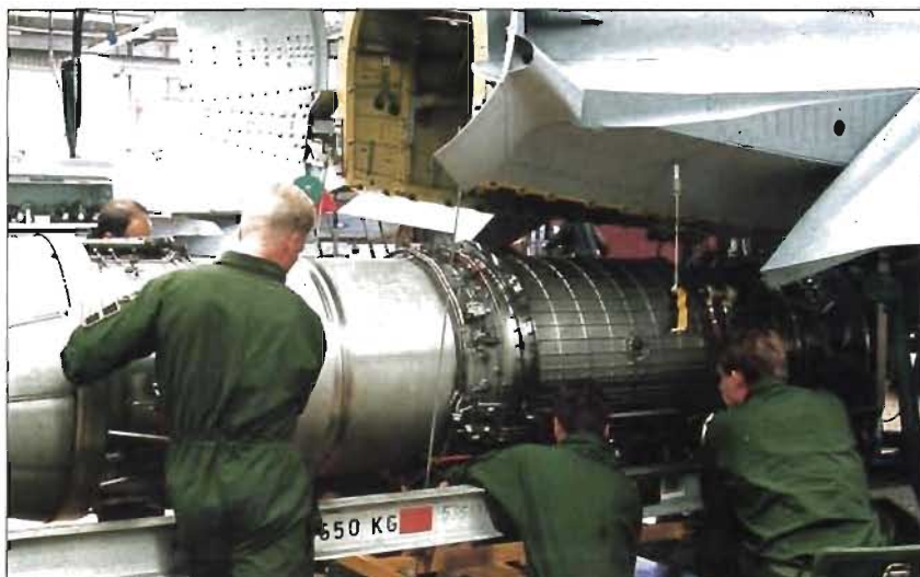
Motorverkstaden vid F 7 har byggts om för att kunna utföra modulbyten på Gripens motor, RM 12.
