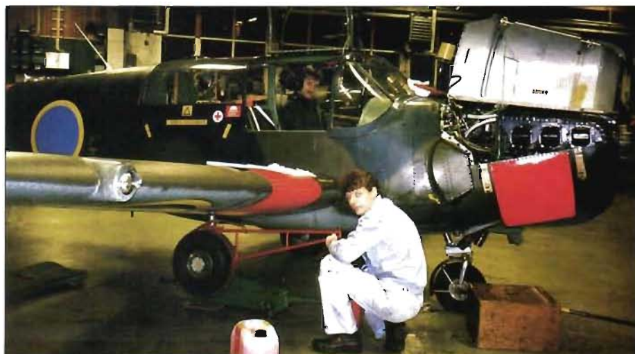
En av Frösö FK:s tekniker, Torsten Ohlsson (på hangargolvet), i arbete med SK 50-individen KYD:s hjulbromsar.
