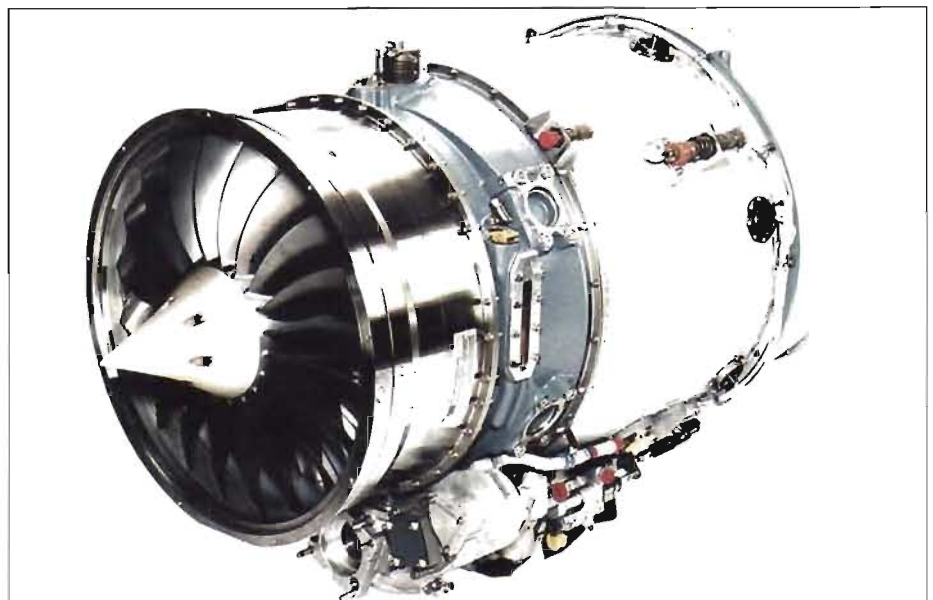
Den nya SK 60-motorn har döpts till RM 15 och är amerikansk; Williams FJ44.
