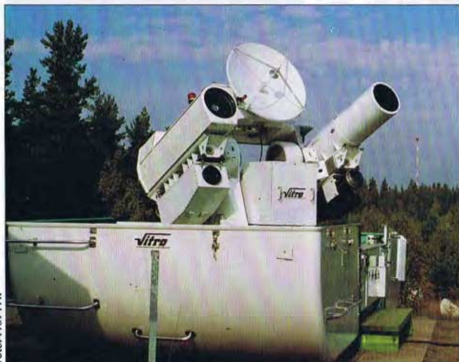
Optical Tracking System/OTS – telemetri. Följning av provobjekt sker med TV- eller IR-teknik.
