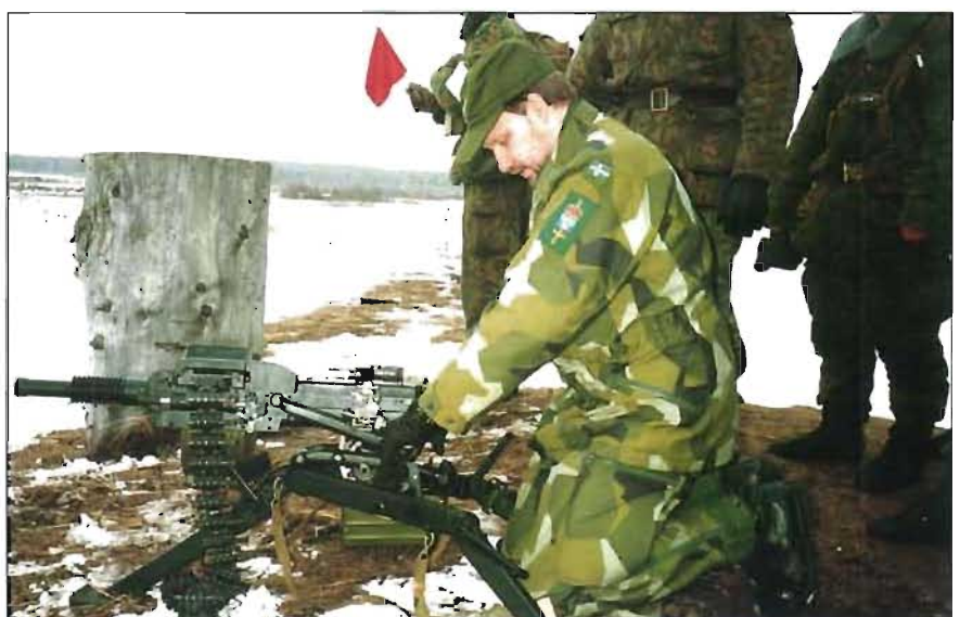
Major Sandqvist provskuter AGS-17 (30 mm granatspruta). Praktiskt skjutavstånd 1000 m, 29-skotts magasin, 1 skott/sekund.
