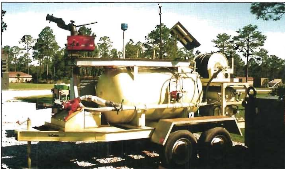
Obemannat släcksystem framtaget för bl a snabbtanking.
