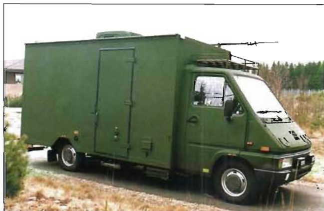
Från och med den 1 juli 1995 förändrades Undpluton S 37 till Undpluton AJS. Detta för att klara de nya krav med införandet av datastavar, videoregistreringssystem, varnar- och motmedelssystem samt ny utvärderingsutrustning för fototolkning. Utöver det får förbanden en sambandsbil, MOBISAM. Bilen innehåller allt det samband som krävs för AJS-förbanden när dessa inte är grupperade i en Bascentral.
