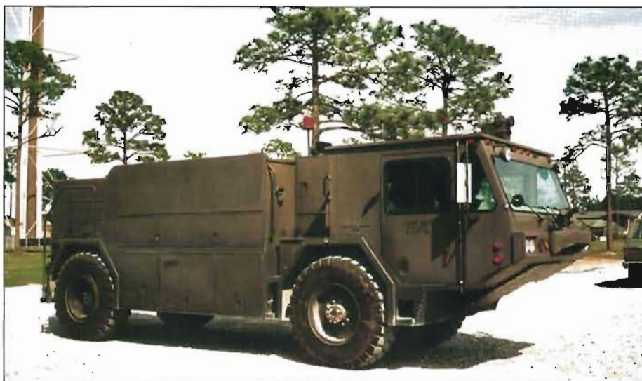
OSHKOSH P-19 Crash truck byggd för att kunna transporteras med C-130 Hercules.
