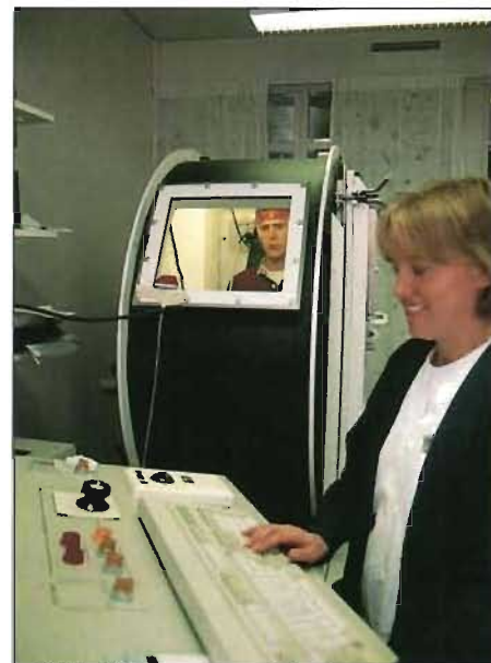
I minitryckkammaren mäts öronens tryckutjämningsförmåga.
