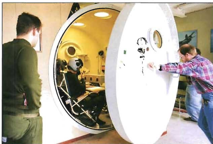
Ovan: Den tunga tryckkamarporten avskärmar piloterna hermetisk från yttvärlden.
