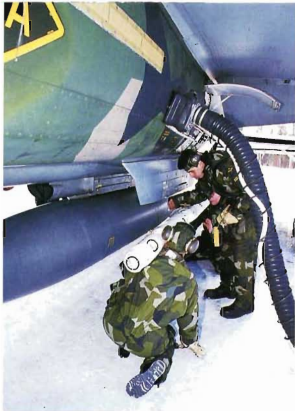
En laserreflektorpod monteras på en Viggen. Reflektorerna användes för att luftvärnet skulle kunna utvärdera sina "träff"-resultat.
