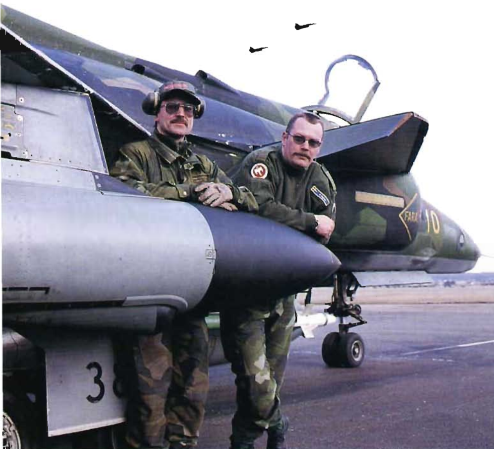
Löjtnanterna André Caldenius och Ronny Hagman tjänstgör som flygtekniker vid 1. kompaniet vid F 10 i Ängelholm. Närmast i bild ses en motmedelskapsel benämnd U221A.
