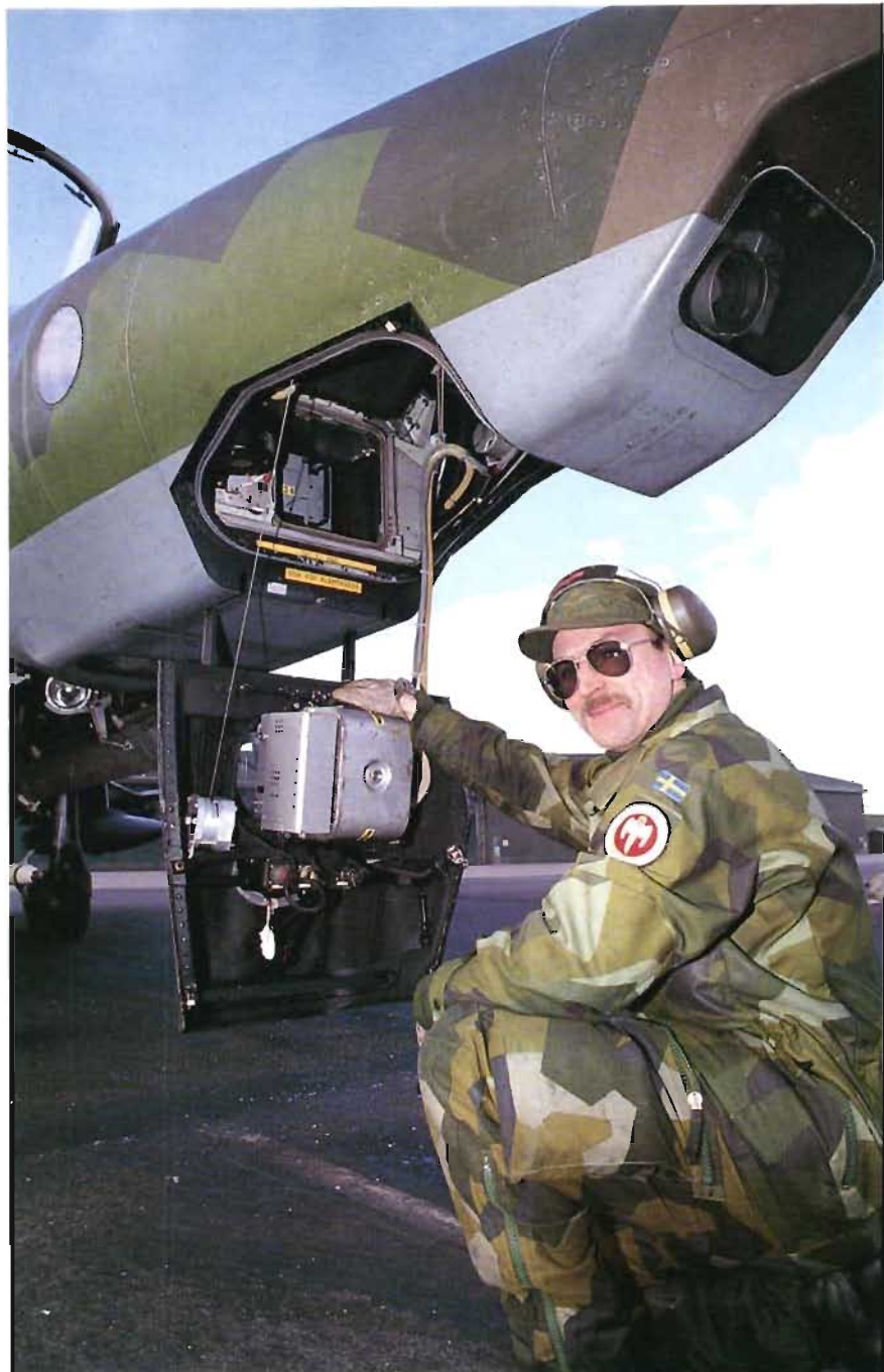
Löjtnant André Caldenius vid en av kamerorna i spanings-Viggens nosparti. Kameran betecknas SKA 24. Dess filmmagasin rymmer en film som är 126 mm bred och hela 45 meter lång. Drygt 700 bilder ryms på filmen.
