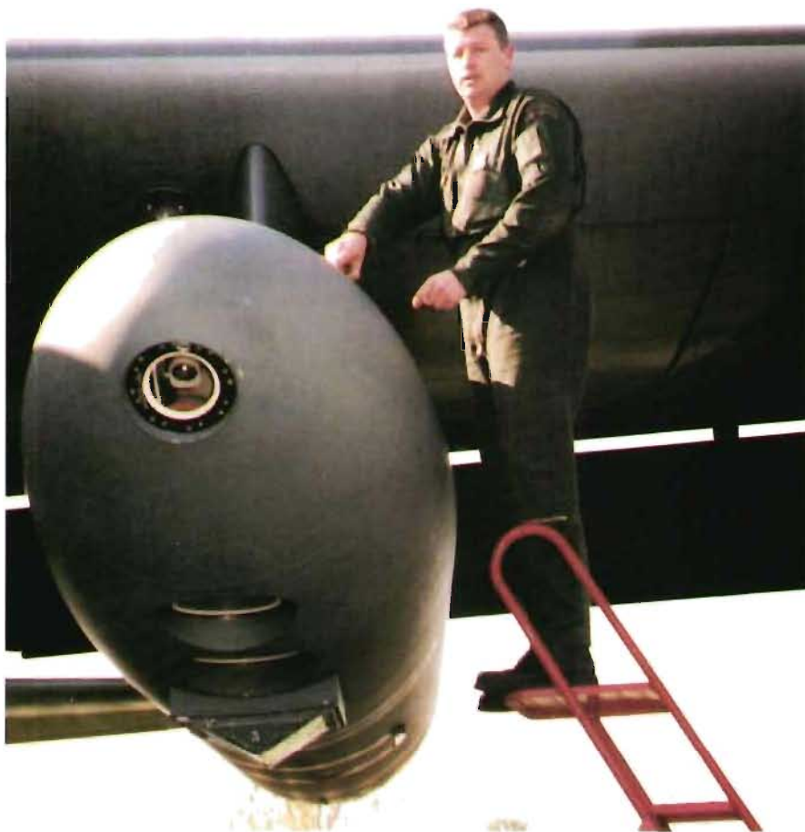
Kamerautrustning för spaningsflygning inom Open Skies monterad i en kapsel på en engelsk C-130 Hercules. Foto: André Caldenius
