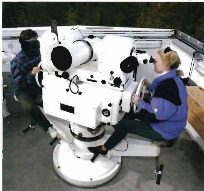
Provskjutningarna registreras med hjälp av kinoteodoliter.
