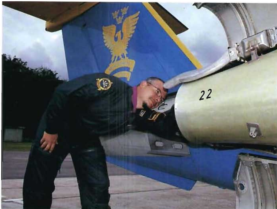
Thomas Stenfeldt inspekterar utloppet på en av motorerna.
