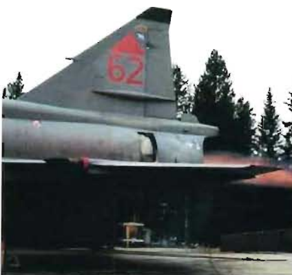
Provkörning av RM 8B efter motorbyte på Optands flygfält.
