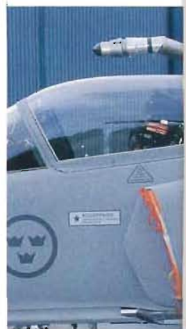
Lufttankningsröret fälls ut fr
