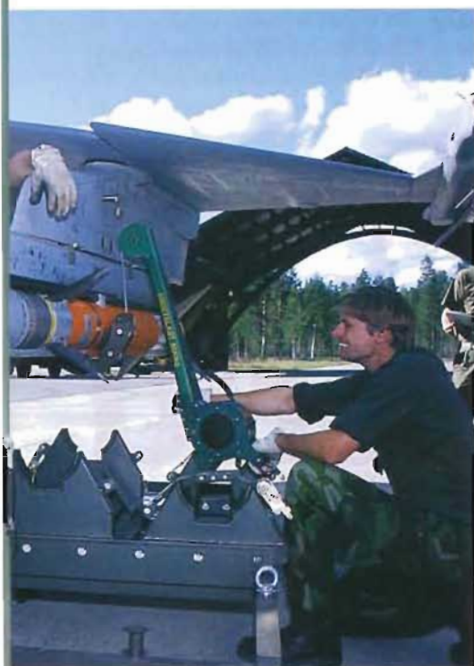
RB 99 Amraam hängs på en av vingbalkarna inför skjutprovet i Vidsele.
