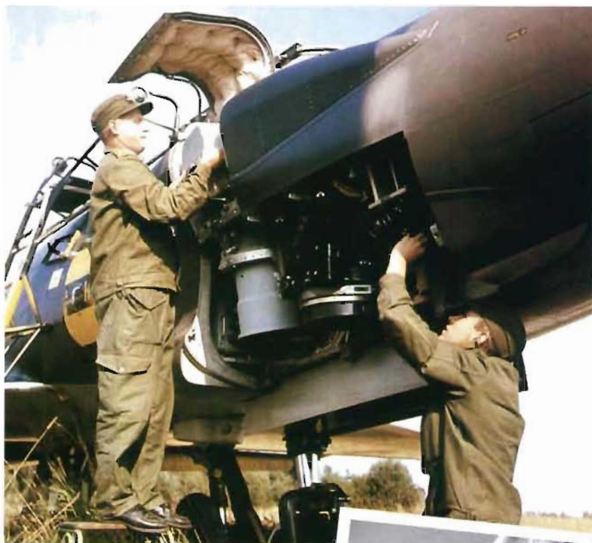
Lansens spaningsversion S 32C hade nosen fylld med kameror som gav bilder av hög kvalitet.
