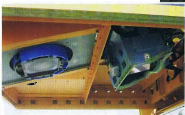
Den flygspaningskamera som det svenska Open Skies-flygplanet ska utrustas med förevisades i en tysk C-160 Transall vid ett besök på F 16 i Uppsala. Den ses till vänster på bilden ovan, tillsammans med en IR-kamera avsedd för fotografering i mörker.
