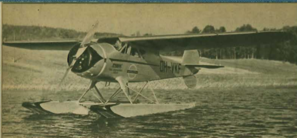
Detta taxifygplan av typ Cessna har Karhuflottörer, som tillverkats vid den finska fabriken Veljekset Karhumäki O/Y. Flottörerna se förtroendeingivande ut och torde få många vänner när de nu komma att tillverkas i Sverige.
