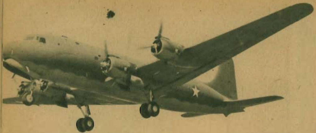
En ypperlig bild av Douglas C-54, ett av krigets mest använda transportflygplan och ett plan, som SILA och ABA äro mycket intresserade av. Lagg märke till det originella arrangemanget för det infällbara noshjulet.
