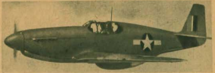
P-51 A «Mustang» med 1 150 hk Allisonmotor. Maxhastighet c:a 565 km/t.
