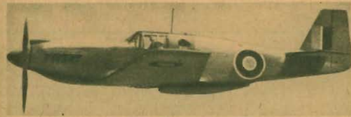
P-51 B «Mustang» med 1 520 hk Packard Rolls-Royce «Merlin LXVIII» (lätt modifierad «Merlin LXI»). Maxhast. c:a 650 km/t.
