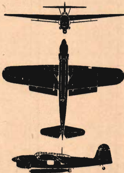
FAIREY „BARRACUDA“ med Rolls-Royce „Merlin 32“-motor i översiktsritning. Lägga märke till de stora vingklaffarna, som närmast ge intryck av hjälpvingar. Inga uppgifter om yttre mått eller prestanda ha ännu frigivits.
