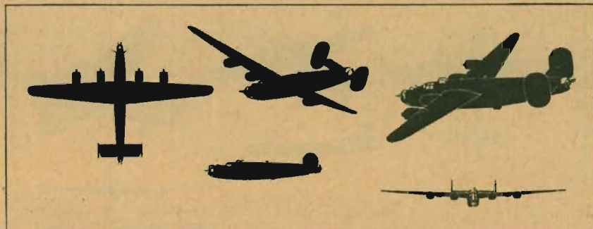
Bomblast: 4.000 kg. Spännvidd: 33,53 m. Längd: 19,51 m. Höjd: 5,79 m. Vingyta: 97,55 m 2 .
