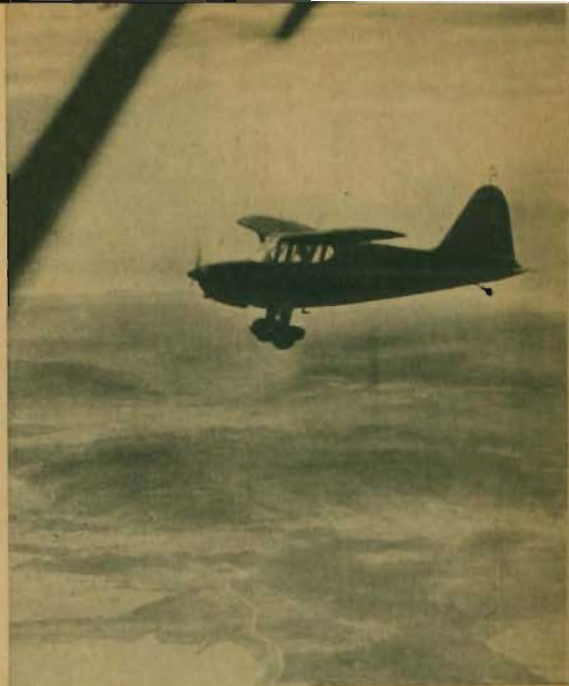
Det högvingade sportplanet kommer att stå sig i konkurrensen med det lågvingade i många år. Här flyger en tresitsig Stinson 105, med 75-90 hk motor, föregångare till »Voyager», över Lake Sammamish öster om Seattle.
