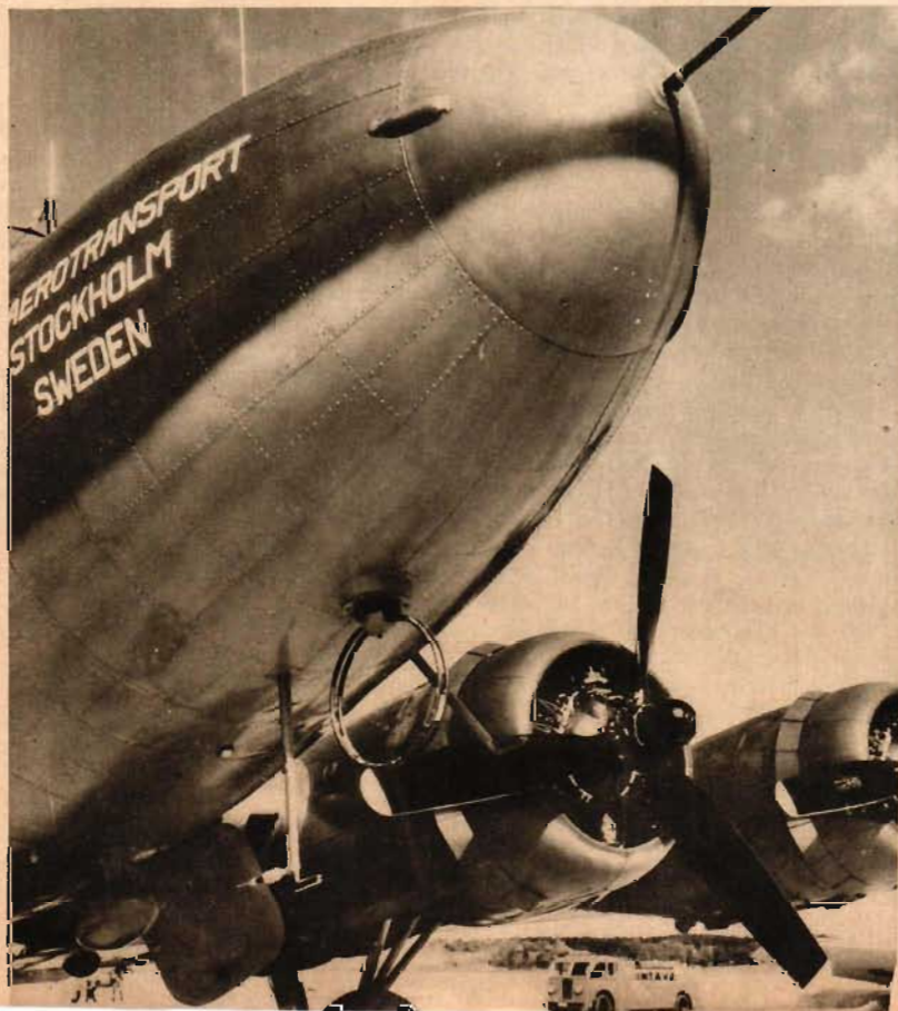
Nosen har förlängts och nospetsen utgöres av en lucka, varigenom främre lastrummet nås.
