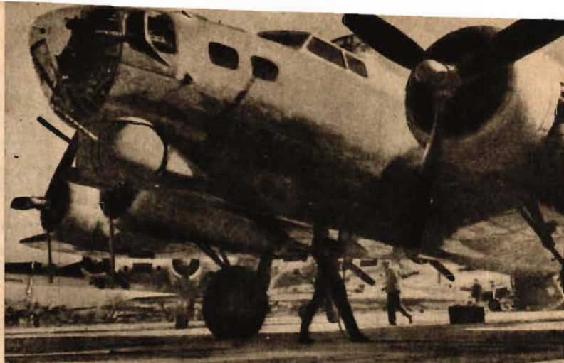
B-17 G vid en Air Service Commanddepå under förberedelserna för provflygning efter omändringsarbeten. Haktornet och den något modifierade nosen framgå tydligt av bilden.
