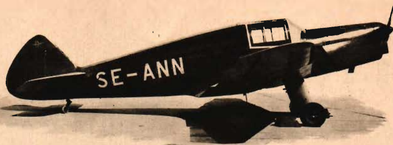
Stockholms flygklubbs nyförvärv, en KZ-II-Coupe med fasta slots. — På bilden t. v. förarsitsen med instrumentbrädan. Sedan fotot togs har variometer och instrumentbelysning tillkommit. Handtaget närmast brädan är till hjulbromsarna. — Undre bilden visar vänster vingens slot, bestående av en höjd »piätremsa», som tvingar luftströmmen att följa vingens översida.
