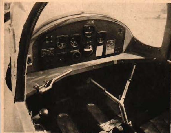
Stockholms flygklubbs nyförvärv, en KZ-II-Coupe med fasta slots. — På bilden t. v. förarsitsen med instrumentbrädan. Sedan fotot togs har variometer och instrumentbelysning tillkommit. Handtaget närmast brädan är till hjulbromsarna. — Undre bilden visar vänster vingens slot, bestående av en höjd »piätremsa», som tvingar luftströmmen att följa vingens översida.
