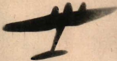
HE 111. Tvåmotorigt. Enkelt stjärtsidplan. Vingens bakkant urupen invid flygkroppen. Elliptiskt stjärthöjdplan. Jfr Ju 88, Blenheim.
