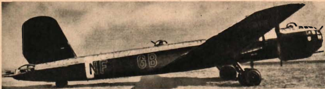
Heinkel He 177. På bilden ovan ses alla skjutplatserna. — T. h. akterskytten med uppfäld huv. — T. v. de fribärande landställbenen och haktorret. — Nedan: stjärtpartiet.
