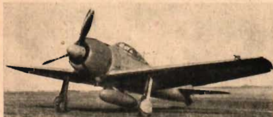
Det japanska jaktplanet Mitsubishi S-00-2, kallad »Hamp» ses här ovan med extra bränsletank under kroppen. — Nedan det amerikanska trafikplanet Consolidated 39, som beskrevs i FLYG nr 18/44.
