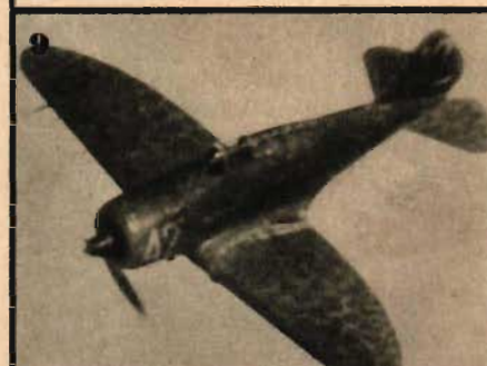
9 J 20: Tjock flygkropp. Långsträckt kabinhuv. Rak vinge. Pilformad stablissator. Avrundad bakkant på vingen. Jfr. J 9, Brewster Buffalo.
