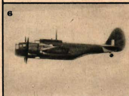
6 BALTIMORE: Tvåmotorigt. Enkelt stjärtsdplan. Karakteristiskt »steg» i flygkroppen på undersidan.
