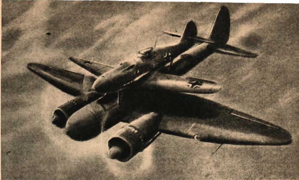
ETT AV HITLERS HEMLIGA VAPEN men knappast något av de ordinarie »vedergällningsvapnen» är ovanstående kombination, som består av en obemannad, sprängladdad Ju 88 på vars rygg sitter en Messerschmitt Me 109. Föraren i Me 109 för båda planen intill målet och frigör där Ju 88:an, vilken störtar och sprängs. Ett dyrbart sätt att bomba och icke heller särskilt exakt.
