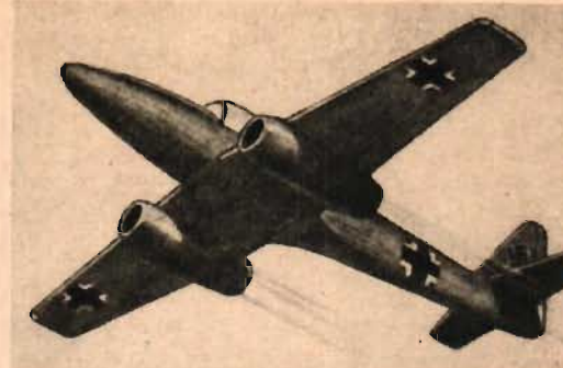
TYSK REAKTIONSJAKT. Här ovan ses en teckning av AEROPLANE av det ensitliga tyska reaktionsjaktplanet Messerschmitt Me 262, utrustat med 2 st Junkers Juno 004 gasturbinaggregat. Beväpningen består enligt en tysk radiorapport av 4 st 30 mm akan. Me 262 har också utrustats med bombställ och använts som låganfallsplan mot de allierade trupperna i Belgien och Holland.
