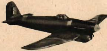
TYPHOON: Lågvingat. Stor, karakteristisk kylare under motorn. Stjärtsidplan och stjärthöjdplan avrundade. Långt framskjutande kanoner i vingarna. Jfr Tomahawk.
