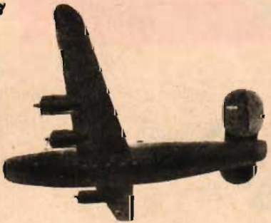
LIBERATOR: Fyrmotorigt. Dubbla stjärtsidplan, ellipsformade. Högvingat. Tjock flygkrupp med rak översida och svängd undersida. Jfr Ju 290.
