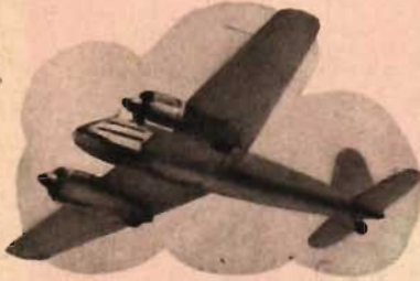
HS 129: Tvåmotorigt. Enkelt stjärtsidplan. Tvärvaskurna vingspetsar. Kort framåtlutande nos. Jfr Me 210, S 16, FW 187.
