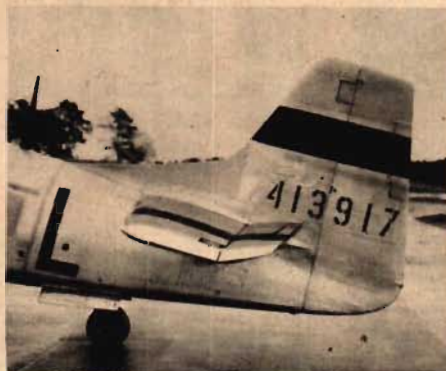
P-51 D har försetts med ny fena, lägre än tidigare och förlängd utmed kroppens översida som på Boeing B-17.
