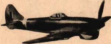
TEMPEST: Stor kylare i nosen. Droppformad huv. »Fortressfena.» Jfr Hurricane, Typhoon.
