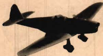
SK 15: Lågvingat. Fast landningsställ med två ben. Hjulkåpor.
