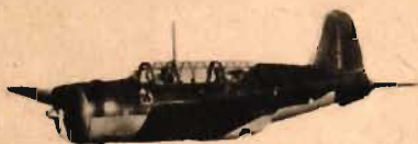
B 17: Mldvingat. Tjock flygkropp. Stor långsträckt överbyggnad av glas. Landningställskåpa synlig under vingen. Liten spjåfena under stjärtspetsen. Jfr Helldiver, Avenger, 8U-2.
