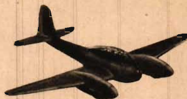
Me 210: Tvåmotorigt. Enkelt, bögt stjärtstälplan. Kort framsluttande nos. Långt framskjutande smala motorer. Obs.: Beväpning på flygkroppens sida bakom vingen.
