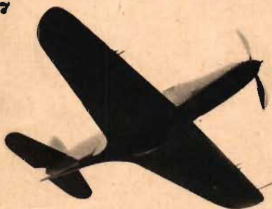
AIRACOBRA: Långt framskjutande spetsig nos. Beväpning synlig i propellerkåpan. Avrundad övergång mellan vingens bakkant och flygkroppen. Pilformig stabilisator.
