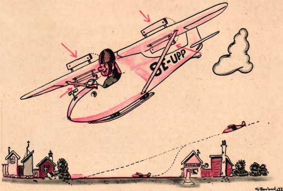
GÖSTA FORSLUND SOM PEDAGOG: I samband med artikeln om dykbromsar och störlkaffar på föregående sida passar det bra med en kompletterande teckning av »Forsslund-Gävles, visande Babyns dykbromsar (obs ej störlkaffar!) i utfällt läge. Som synes skulle föraren inte kunna ta sig ner där borta mellan husen utan att använda dykbromsarna. Teckningen ingår i Gösta Forsslunds instruktiva färgfilm för Gävlebygdens flygklubb.
