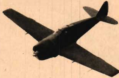
J 22: Tvårävskurna vingspetsar. Låg, triangulär fena. Trubbig nos. Flygkroppens översida sluttar kraftigt bakåt mot stjärten. Jfr Fw 190, Hellcat.
