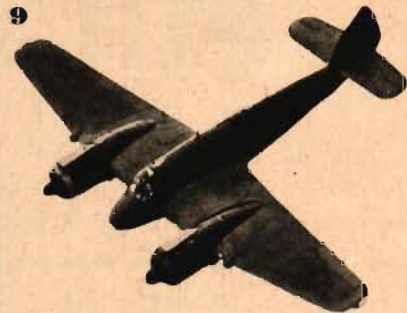
BEAUFIGHTER: Tvåmotorigt. Enkelt stjärtsidplan. Fenans framkant avrundad. Kort nos. Jfr Mosquito, Hs 129.
