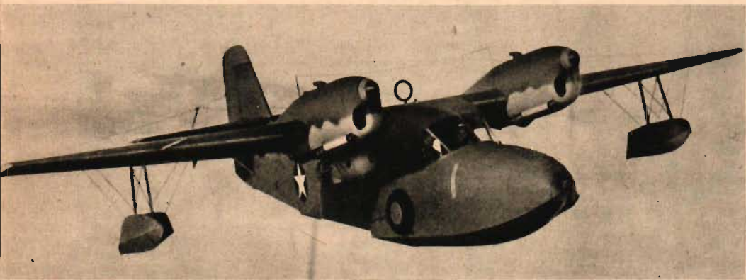
Typ nr 2: Grumman »Widgeon» (ovan), amerikansk tvåmotorig amfibie av helmetall med summa 400 hk och plats för 4—5 personer. Maxhast 255 km/t.
