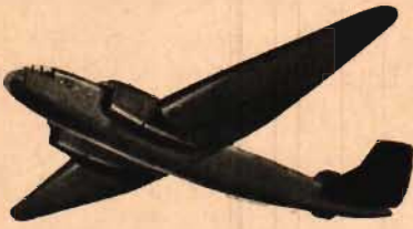
JU 86 P: Tvåmotorigt. Dubbla, kantiga stjärtsidplan. Långt framskjutande smala motorer. Flygkroppens undersida uppsvängd bakåt. Stjärtkon. Jfr B 3.
