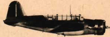
B 17: Tjock flygkropp. Stor, glastäckt överbyggnad. Kåpor för landningsställlet synliga under vingen. Liten spinfena under stjärtpetsen. Jfr Vengeance.
