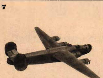
LIBERATOR: Fyrmotorigt. Dubbla elliptiska stjärtsidplan. Högvingat. Tjock flygkropp. Kspstorn i stjärten och på flygkroppens översida. Jfr Lancaster, Halifax.
