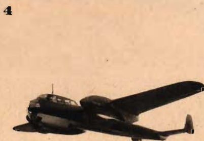
Do 215: Tvåmotorigt. Dubbla stjärtsidplan. Plant stjärthöjdplan. Stor trubblig uppbyggd glastäckt nos. Jfr B 18 B.
