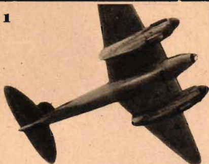
MOSQUITO: Tvåmotorigt. Enkelt stjärtsidplan. Hängande motorer. Kort nos. Vingens framkant mellan motorerna skjuter längre fram än vingen i övrigt. Elliptiskt stjärthöjdplan. Ving med omvänd pllform. Jfr Beaufighter.
