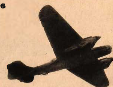
SB-3: Tvåmotorigt. Enkelt stjärtsidplan. Stark pllform på stabilisatorn. Trubblig glastäckt nos. Avrundad övergång mellan vingens bakkant och flygkroppen. Kraftiga kylare under motorerna. Jfr SB-2, DB-3.
