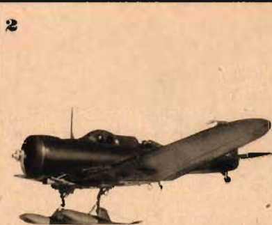
B 5: Fast landningsställ. V-formad vinge. Bred motorhuv.
