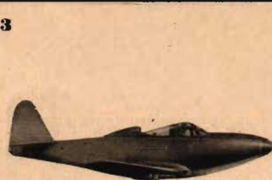
KINGCOBRA: Lågvingat. Lång spetsig nos. Smal flygkropp med svängd undersida. Hög sockertoppsformig fena. Luftintag bakom huvan och i vingens framkant invid flygkroppen. Jfr Airacobra, Mustang.
