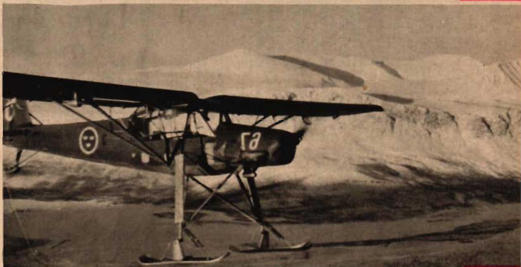
De två »fjällstorkarna» står här nedan startklara i gryningen, väl varmkörda av de morgonpigga mekanikerna. Observera träcklossarna under skidorna för att hindra att dessa fryser fast vid snön.
