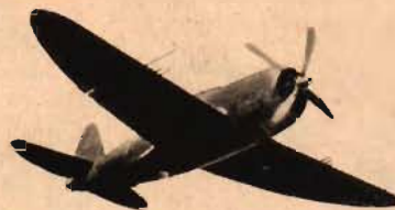
THUNDERBOLT: Tjock flygkropp. Lång, smal spinner osymmetriskt placerad i motorhuv. Vingens bakkant avrundad. Pilformig stabilisator. Jfr J9, Helldiver.
