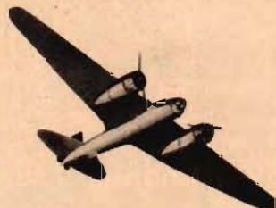
SB-2: Tvåmotorigt. Enkelt stjärtsidplan. Kort nos. Pilformigt och bakåt utdraget stjärthöjplan. Avrundade övergångar mellan vingens bakkant och flygkroppen. Stjärnmotorer. Jfr Beaufighter, Mosquito, Hs 129.
