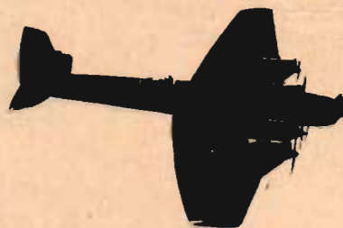
TB-3: Fyrmotorigt. Enkelt stjärtsidplan. Högst och upptill tvärvaskuret sidroder. Långt framskjutande nos. Tvärvaskurna vingspetsar. Jfr TB-7.
