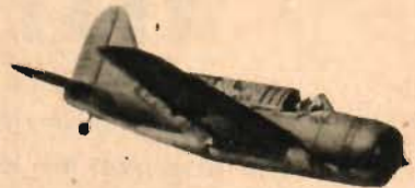
BUCCANEER: Tjock flygkropp. Hög fena. Hög, långsträckt överbyggnad. Perforerade vingklaffar. Jfr B 17.
