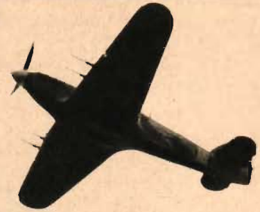
HURRICANE: Lågvingat. Avrundad övergång mellan vingens bakkant och flygkroppen. Rundade stabilisatorspetsar. Kylare skymtar svagt under flygkroppen framför vingens bakkant. Fyra st långt framskjutande vingspjävar. Jfr Spitfire, Me 109.
