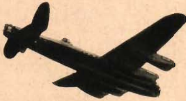
LANCASTER: Fyrmotorigt. Dubbla, äggformade stjärtsidplan. Ruk, ganska jämtjock flygkropp. Långt framskjutande motorer. Ksp torn i stjärten och på flygkroppens översida. Jfr Halifax.
