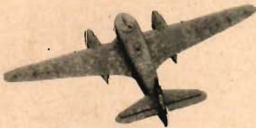
S 16: Tvåmotorigt. Enkelt stjärtsidplan. Flygkropp med fyrkantig tvärsnitt. Motorgondolspetsarna synliga bakom vingen. Rörlik ksp i kupol på flygkroppens översida. Jfr DB 3F, Avro Anson, AR-2.
