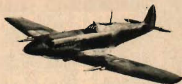
SPITFIRE XII: Lågvingat. Tvåravskurna vingspetsar. Uppått spetsigt stjärtsidplan. Långt framskjutande kraftiga vingpjäser. Jfr Me 109, »Hurricane».
