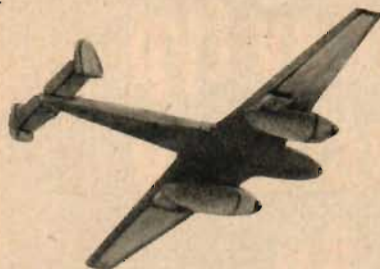
ME 110: Tvåmotorigt. Dubbla äggformade stjärtsidplan. Smal, spetsig nos. Tvåravskurna vingspetsar. Smal flygkropp. Jfr Pe-2.
