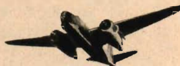
BOSTON III: Tvåmotorigt. Enkelt stjärtsidplan. V-format stjärthöjdplan. Hängande motorer med stora motorgondoler. Jfr »Marauder».
