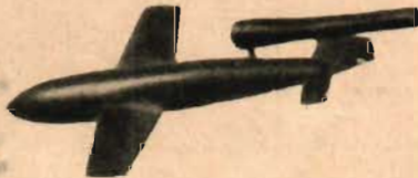
V 1: Ett reaktionsaggregat i stjärten på flygkroppens översida. Små tvårävkurna vingar.
