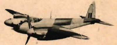
MOSQUITO: Tvåmotorigt. Enkelt stjärtsidplan (liknande hafferna). Nosen spetsig i jämhöjd med motorerna. Jfr Beaufighter, Hs 129, Me 210.
