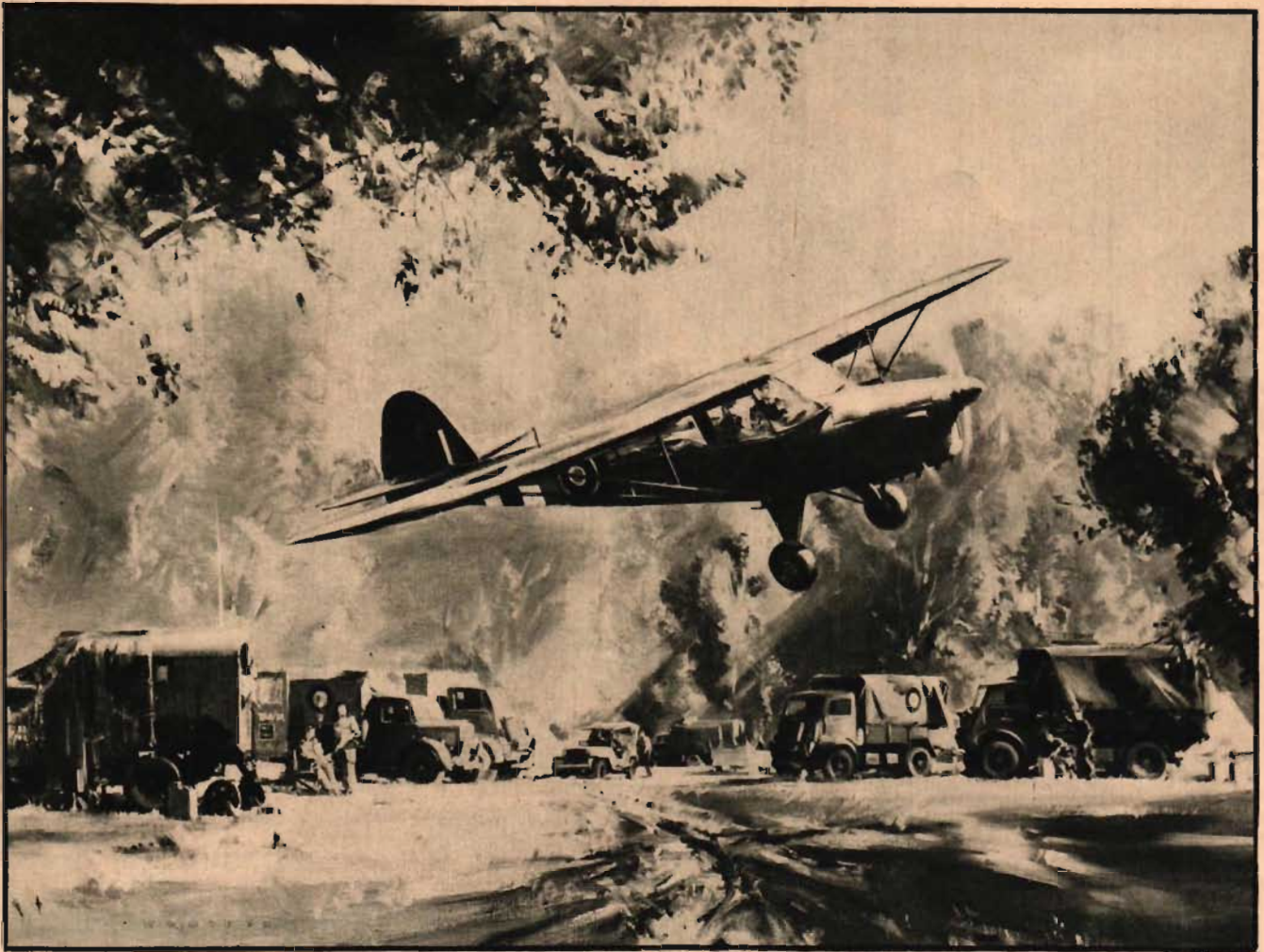
En Taylorcraft Auster III, lätt monoplan, landar vid ett av RAF:s högkvarter vid fronten. Utrustade med 130 hk Gipsy Major-motorer användas dessa små vagabonder av de allierade styrkorna för samband och spaning.
