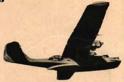
CATALINA: Centralflytkropp. Enkelt stjärtsidplan. Högt ansatt stabilisator. Tvårävkurna vingspetsar. Glastäckta utbyggnader på flygkroppens sidor bakom vingen.
