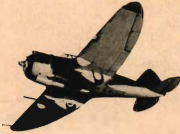
J 9: Vingor med rak framkant och elliptisk bakkant. Starkt pilformad stabilisator. Runda kåpor för landningsstället sticker långt ned under vingarna. Jfr J 20.
