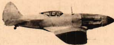
MIG-3: Lågvingat. Kort avstånd mellan vingor och stabilisator. Starkt pilformad stabilisator. Lång symmetrisk spetsig nos. Utbyggt övergång mellan vingens bakkant och stabilisatorn. Jfr Lagg-3, Me 109, Spitfire.
