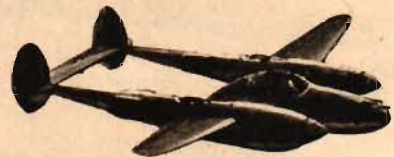
LIGHTNING: Tvåmotorigt. Stjärtbombmar. Ovals stjärtsidplan. Långt framskjutande centralkropp. Utväxter på bommarnas sidor. Jfr J 21.
