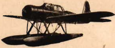
ARADO 196: Två flottörer. Lågvingat. Hög, långsträckt överbyggnad av glas. Flera flottörstötter. Jämbreda vingar med runda vingpetsar. Jfr S 178.
