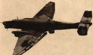
JU 86 K: Tvåmotorigt. Dubbla kantiga stjärtsidplan. Långt framskjutande nos. Sänkbart torn under flygkroppen. Obs.: Spaltvinge. Jfr B 3.
