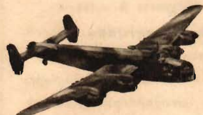
HALIFAX: Fyrmotorigt. Dubbla, framåt plattformade stjärtsidplan. Högt ansatt stabilisator. Nos- och stjärtorn. Jfr Lancaster.
