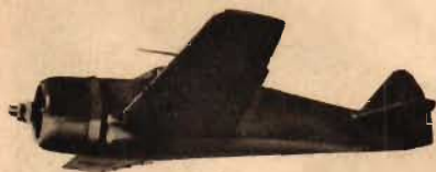
J 22: Kort nos. Tvärvaskurna vingspetsar. Något buktig undersida. Luftintag i vingroten. Jfr Fw 190, Grumman »Wildcat».
