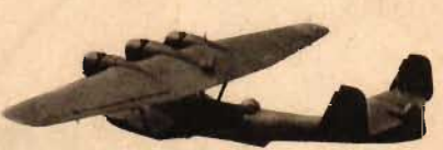
Do 34: Tremotorigt. Dubbla stjärtsidplan. Centralflytkropp med hjälpvinge. Kaptorn i stjärten och på flygkroppens översida bakom vingen. Jfr Catalina.
