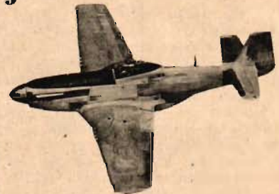
P-51D MUSTANG: Lågvingat. Tvärvskurna vingspetsar. Flygkropp med kraftig kylare på undersidan. Droppformad huv. Uppptill tvärvskuret stjärtsidplan (senare vers »fortress-fens»). Stjärthöjdplan högt ansatt och långt fram. Jfr Spitfire, Airacobra.
