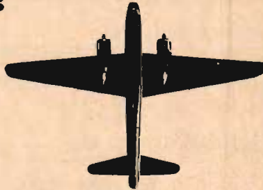
WELLINGTON: Tvåmotorigt. Rak jämntjock flygkropp med stjärtnorn. Långt framskjutande nos. Pilformigt enkelt stjärtsidplan. Jfr Whitley.
