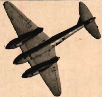
MOSQUITO: Tvåmotorigt. Vingens framkant mellan motorerna skjuter längre fram än vingarna i övrigt. Nosen i jämnhöjd med motorerna. Elliptiskt stjärthöjdplan. Jfr Me 210.
