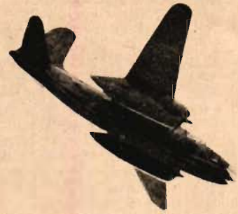
BOSTON: Tvåmotorigt. Enkelt stjärtsidplan. Flygkroppen uppsvängd bakåt. Motorgondolerna utdragna bakom vingen. Jfr Marauder.
