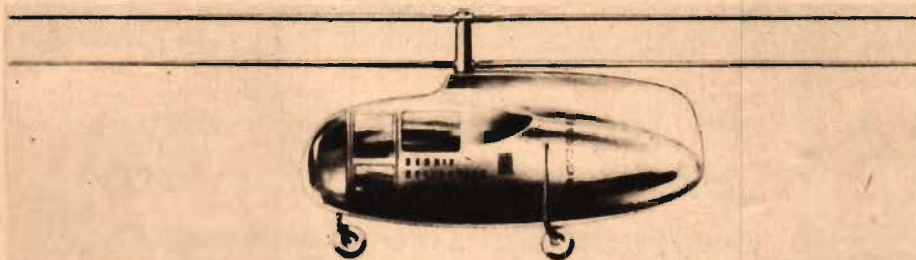
Bendix fyrsitsiga helikoptermodell I (ovan) har 300 hk motor och modell H (nedan) 500 hk. Båda typerna har två motroterande rotoror och nosjul. Enligt ett meddelande från fabriken skall modell I (och varför inte också H?) bli den hittills mest lättflugna helikoptern.
