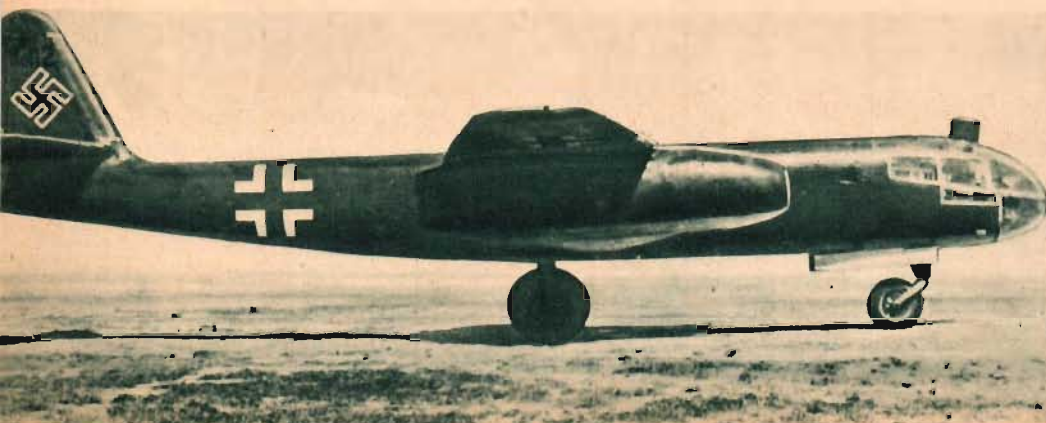
T v ett foto av det tyska reaktionsdrivna spaningsbombplanet Arado Ar 234B, utrustat med två st JUMO 004B reaktionsaggregat. Den tornliknande kåpan ovanpå glasnosen säges vara ett kombinerat periskopsikte för bombfällningen och den defensiva beväpningen.
