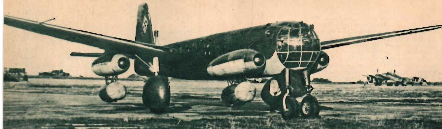
Här ovan ses prototypen till bombplanet Junkers Ju 287 utrustad med 4 st reaktionsaggregat av typ JUMO 004. För att förbättra startegenskaperna har hjälpraketaggregat monterats under reaktionsaggregaten. Landstället på detta enskilda exemplar är av fast typ men serietypen skulle eventuellt förses med infällbara ställ.
