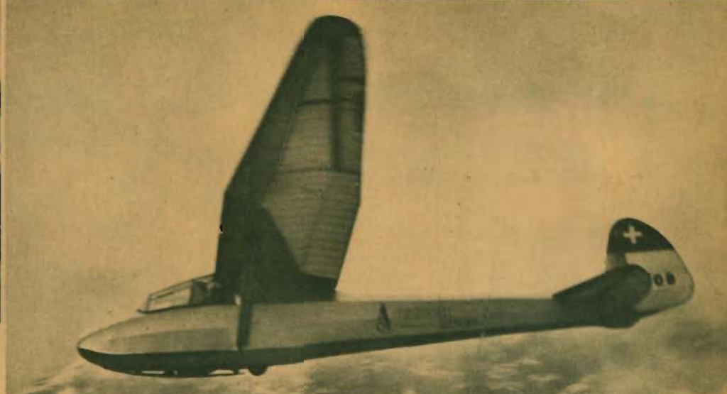
Det tvåsitsiga segelplanet Spalinger S-21 II ses här på tre fotos från hemlandet Schweiz. Kroppen är av stålrör och sitsarna sida-vid-sida men något förskjutna.
