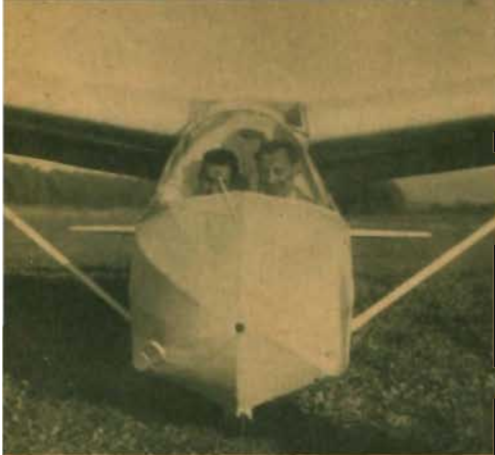
Det tvåsitsiga segelplanet Spalinger S-21 II ses här på tre fotos från hemlandet Schweiz. Kroppen är av stålrör och sitsarna sida-vid-sida men något förskjutna.
