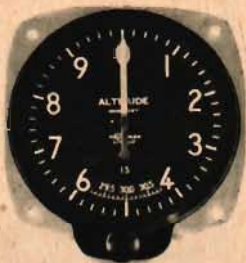
HÖJDMÄTARE , upp till 20.000 fot. Varje grad motsvarar 200 fot. Ett visarvarv är 10.000 fot.
