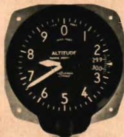
PRECISIONSHÖJDMÄTARE , upp till 20.000 fot. Ett precisionsinstrument som motsvarar de största fordringar.
