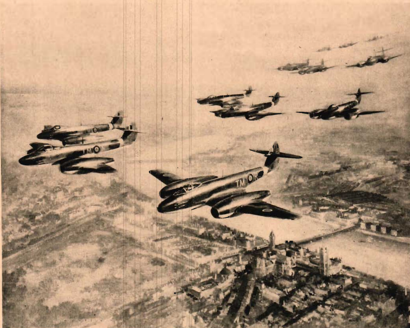
En division militärplan av typ Gloster Meteor IV, drivna av dubbla Rolls-Royce Derwent-gasturbiner. Världarekordet i hastighet på 975 kilometer i timmen sattes med flygmaskiner av denna typ.
