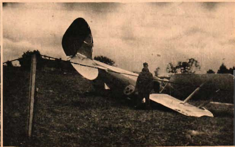
Fig 7. Förankring av ett flygplan.
