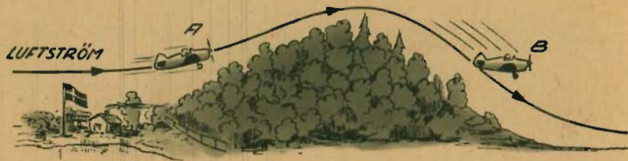
Fig 2 A. Luftströmmarna hjälper flygplanet att stiga. B. Flygplanet pressas ned av luftströmmarna (nedsvep) och har svårt att hålla höjden.
