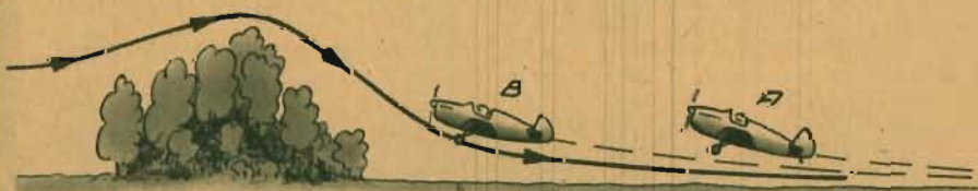
Fig 1. Tvingas man starta mot en mask är det bäst att direkt efter lättningen stiga med bästa stigvinkel som flygplan A. Gör man inte detta utan planar ut och väntar med stigningen kan man komma in i nedsvep och få svårt att komma över masken som flygplan B.
