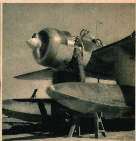
Översyner av olika slag ingår i den dagliga rutinen. BENGT KARLSSON och UNO THÅNG har fått i uppdrag att skruva loss några motorplåtar på en S 12. — Nedan t. v.: KJELL SVEDBERG och en av flottilljens vakthundar, schäferen »BUSS», tar »plats» under en exercisövning i det fria. — Nedan t. h.: För större översyner dras flygplanen upp på landbacken och här håller SVEN-OLOV SCHYBERG på att trimma en S 17-motor.
