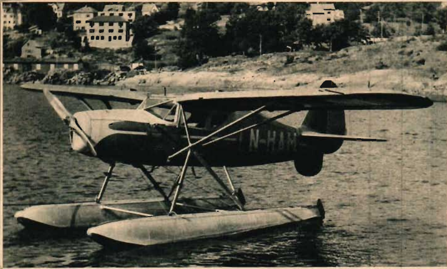
Ett norskt taxiplan av typ Fairchild UC-61K tillhörigt A/S Lufttransport i Aalesund. Planet är utrustat med helmetallflottörer, vilka konstruerats och byggts av Norsk Flyindustri A/S på Fornebu.
