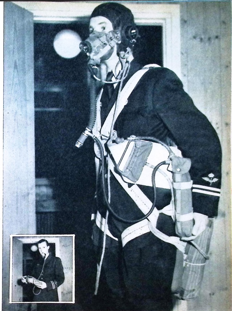
Ovan t. h.: Den nya utrustningen för fallskärmschopp på hög höjd som skall införas på F 13 består av en normal Irwing-skärm med centralås men är försedd med en liten syrebehållare som sitter i ett fodral på vänstra sidan. För att få apparaten i gång behöver man bara dra i utlösningshandtaget ovanför fallskärmsutlösningen. Syrgasen rinner för 10 min. Bakom den invecklade attiraljen döljer sig löjtn. C. F. SCHNELL. — Införd: Den gamla syrgasutrustningen för fallskärmschopp. — Nedan t. v.: Trafikledningen kan på några ögonblick förflytta sig från kontrolltornet t. ex. ner till skyddsrummet genom att som brandsoldater åka ner för denna stång. Här är furir LARS GREDDIN på väg till kanslihusets nedre regioner. — I mitten: Så här ser F 13:s UK-radioanläggning ut. Det är trafikledare OTTO JOHANSSON som håller i mikrofonen. — T. h.: Trafikledare AGNE PETTERSSON visar på lappen »Plané 4 m/sek.», och furir LARS GREDDIN vidarebefordrar meddelandet till en J 28 som just är på väg att landa med hjälp av radar och UK-pejling.
