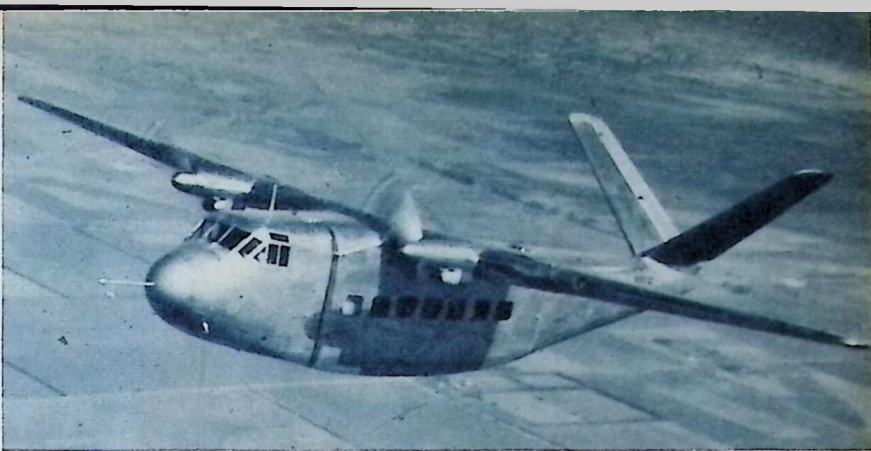
Beechcraft Twin-Quad som det nya flygplanet på bilden kallas har flera intressanta nyheter i konstruktionen. Planet har sålunda motorerna inbyggda i vingarna (ett system som lancerades på Bristol Brabazon) och de fyra motorerna är kombinerade så att de tillsammans driver två propellrar. Planet har vidare speciella förstärkningar i botten av flygkroppen, vilket minskar kruschrisken vid nödländning, och är även konstruerat med s. k. stabilisera, Twin-Quad som tar 20 passagerare undergår f. n. flygprov i Wichita.
