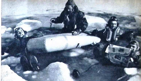
Nå, dessa amerikanska flygare är inga frälsande vinterbadare utan håller endast på att prova en ny flygdräkt avsedd för det amerikanska flottflygets piloter. Dräkten lär rymma en ny slags värmesolator som man dock ännu inte lämnat några uppgifter om. Vid långa flygningar över vatten bör flygaren känna sig tryggare i dessa kläder.
