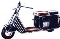
Cuschners, en fyra hästkrafters scooter som under kriget användes i stor utsträckning på flygfält och inom krigsindustrin.
