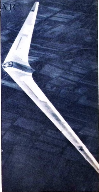
Ovan: Horten IV med ett sidoförhållande på 1:21,2 — förmodligen ett av de högvärldigaste segelflygplan som någonsin byggts. — Nedan t. v.: Horten II med 60 hk motor.
