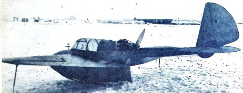
Den Italienska ensitsaren Alaparna A. M. 8 »Lul» med två stjärthommar, enkelt hjul under kroppen och stödpörl under ving-spetsarna.
