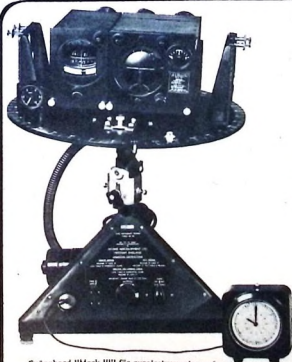
Svängbord "Mark III" för gyrolinstrumentprovning
